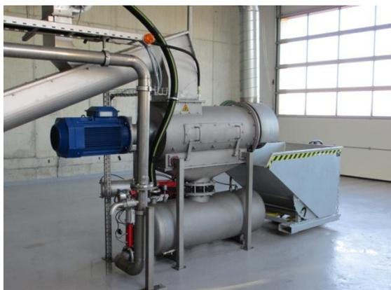
Anders die Verwertung abgelaufener Lebensmittel in der BiEAG Biomasse Energie AG im zugerischen Hünenberg. Im Biomasse-Heizkraftwerk in der Zentralschweiz können abgelaufene Lebensmittel maschinell entpackt, hygienisiert und zu Strom und Wärme verwertet werden.
